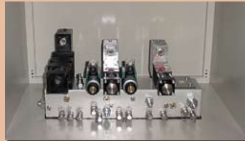
安装于独立控制箱的油压伺服阀
