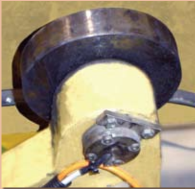
二次臂传感器的安装可直接压上卷轴
